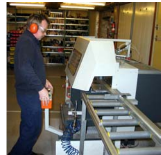
Präzisionsarbeit: Alu-Profile werden zugesägt. Schutzbrille und Hörschutz gehören dazu.
