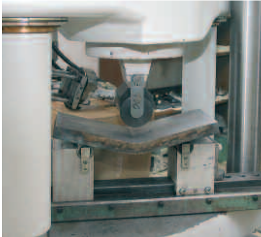
Festigkeitsprüfung eines Stahlblockes.
